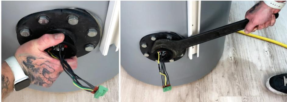
Beim Einschrauben muss der Heizstab ohne Kraftaufwand eingedreht werden, bis die Dichtung leicht anliegt. Den Heizstab am Sechskant mit einem Mausschlüssel Nennweite 60 mm festziehen. Bei der Verwendung einer Rohrzange ist zum Schutz des Sechskants ein Tuch beizulegen!
