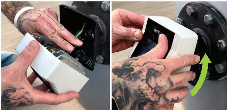
Elektronikeinheit mit Befestigungsschraube (Torx TX20 4x25mm) an den Verbindungsrahmen schrauben.
