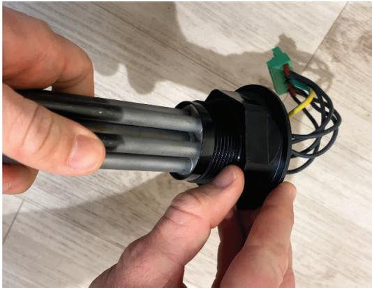
Ist eine Abdichtung mit dem O-Ring nicht möglich, so dürfen andere Dichtmittel am Gewinde verwendet werden.
