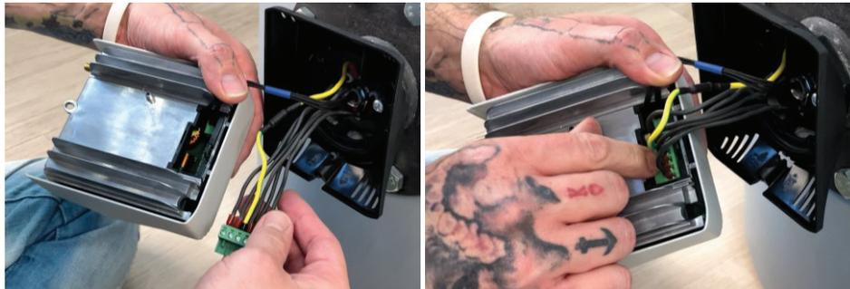
Drähte ordnen und die Elektronikeinheit von unten nach oben in den Verbindungsrahmen einhängen.
