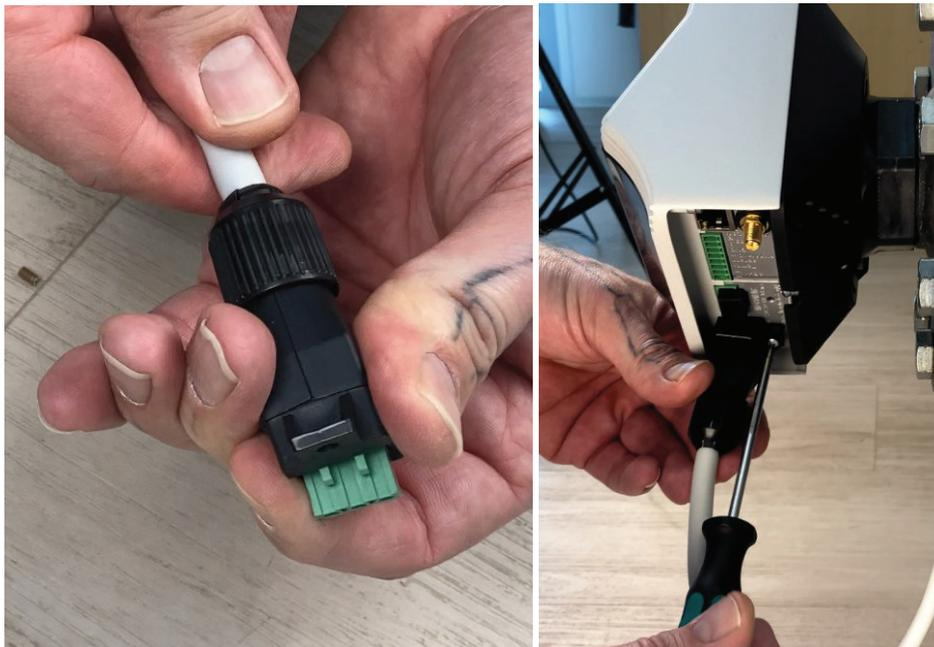
Festen Sitz prüfen. Anschließend das Kabel mit der Zugentlastung mit der Befestigungsschraube (Torx TX10 3x8mm) am Anschluss zur Spannungsversorgung (L PE N) der Elektronikeinheit montieren.
